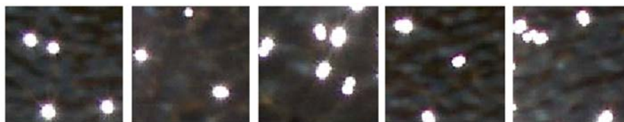
Рис. 8. Образцы из ансамбля изображений солнечных бликов на волнистом бассейне, снятых камерой с высоким пространственно-временным разрешением.
